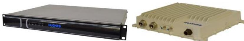
休斯 Jupiter 系统是目前全球高通量卫星运营商最普遍采用的通信平台，为全球首个在实际产品中采用 DVB-S2X 标准（单载波速率达 235Mps），系统集成度高，支持“无人值守”。HT 卫星终端采用休斯自身设计的 SoC-2 系统芯片，每终端吞吐量达 200Mb/s。
